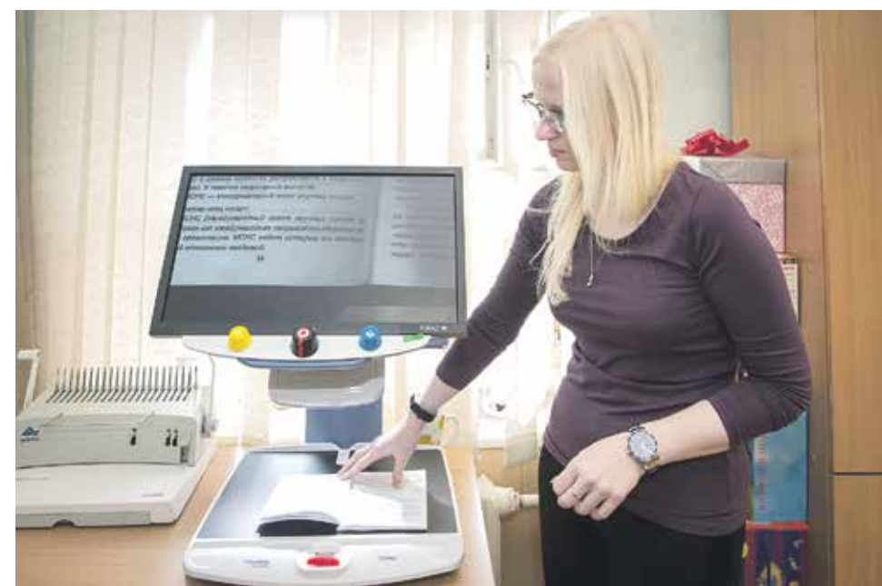
С помощью электронного увеличителя Тораз слабовидящие люди могут читать даже мелкий шрифт. Устройство укрупняет изображение до 16-кратного размера
