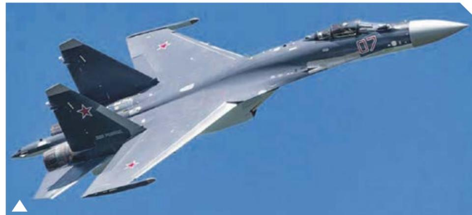
Многоцелевой сверхзвуковой сверхманевренный истребитель Су-35С поколения 4++ оснащен радиолокационной системой «Ирбис», которая может обнаруживать цели на расстоянии 400 километров, одновременно сопровождать до 30 воздушных и 4 наземных объектов, атакуя 8 наиболее опасных. Такие истребители участвовали в операции российских ВКС в Сирии, где прикрывали наши штурмовики и бомбардировщики.
