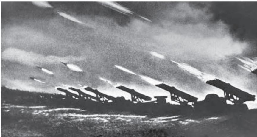
ченный для установки на самолетах, разработали ученые-инженеры Лангемак, Клейменов и другие, а наземную пусковую установку – конструкторы Гвай, Галковский, Павленко и Попов. Новое оружие получило название БМ-13-16 – боевая машина для одновременного запуска 16 реактивных снарядов калибром 132 миллиметра.
