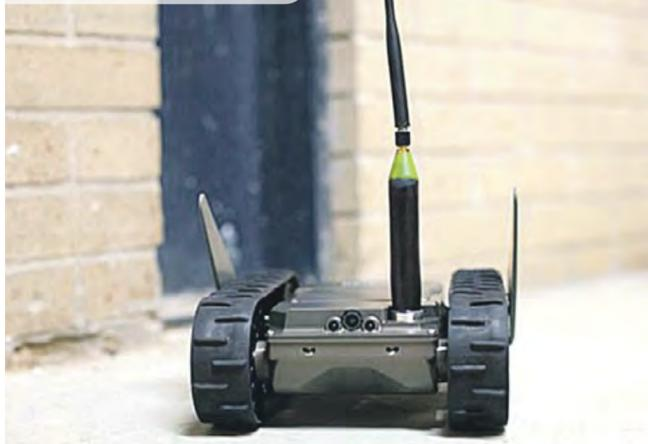
ский рюкзак и проводить разведку в ограниченном пространстве. Создатели позиционируют устройство как робота, «которого можно бросать»: он способен перевернуться, принять исходное положение и продолжить запрограммированную миссию.
